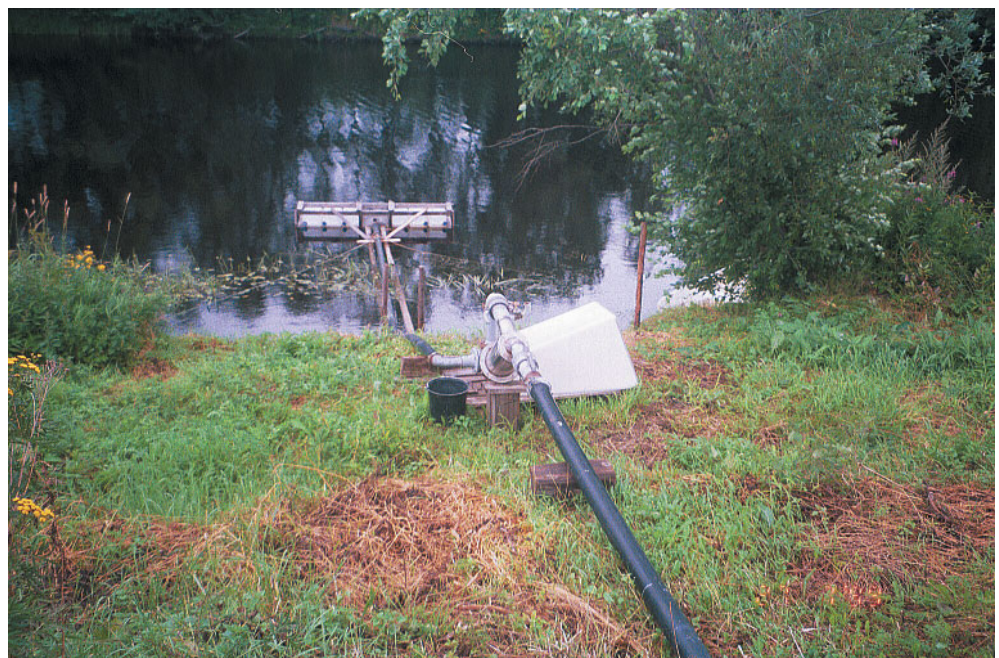
Säätökastelussa joudutaan lisävesi järjestämään useimmiten pumppaamalla, koska luontaista valumaa ei voida käyttää hyväksi.
